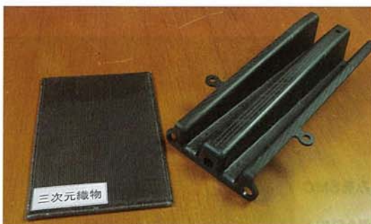
図15 3次元織物とクラッシュボックス クラッシュボックスは先端の面積が小さく、徐々に大きくすることで、先端からつぶれるように制御。
