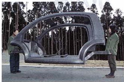
図3 骨格の質量は47kg 骨格は大人2人で持てる程度の軽さである。(写真：山本琢磨)
