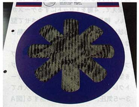
図5 ドイツSGLグループの多軸基材 90度方向が異なる繊維を重ねてステッチして一体化している。BMW社にも同様の材料を供給する。
