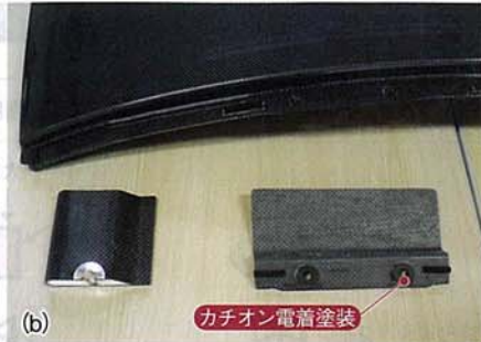
図3 富士重工業「インプレッサWRX STI tS」のルーフ (a)東レのVaRTMで成形し、ルーフ本体の質量は5kgにできた。(b)前後は樹脂製ワッシャを挟んでねじで固定し、左右のナット部はカチオン電着塗装を施した。
