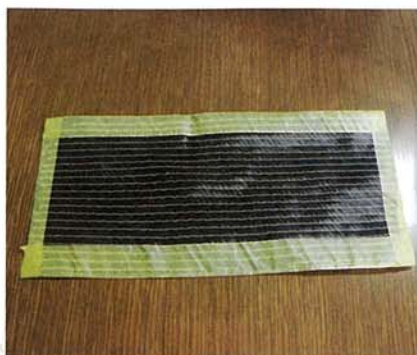
図13 RTM用の多軸基材 BMW社と同様に、90度方向が重なる繊維を2枚重ねてステッチしている。
