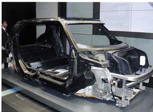
図4 BMW社「i3」の試作ボディ Liイオン2次電池とサスペンションを取り付けるAl合金製シャーシの上に、CFRP製ボディを取り付ける。
