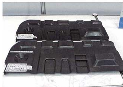
図5 東レらのグループが開発した短繊維を混ぜたシート
