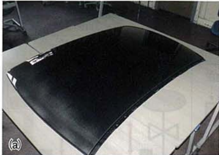
図3 富士重工業「インプレッサWRX STI tS」のルーフ (a)東レのVaRTMで成形し、ルーフ本体の質量は5kgにできた。(b)前後は樹脂製ワッシャを挟んでねじで固定し、左右のナット部はカチオン電着塗装を施した。
