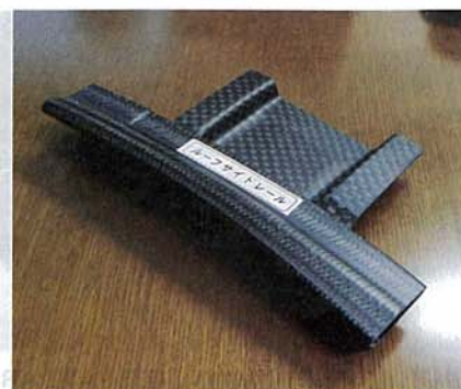
図14 プリフォームを組物で作ったAピラー 中空形状のプリフォームを組物で作製。端材を活用したブラケットとRTMで一体成形する。
