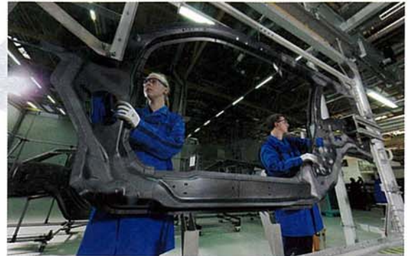
図7 i3のサイドパネル 小さな部品に分けてプリフォームを作成し、重ねしをステープラーで留めて固定。RTM成形で一体化する。
