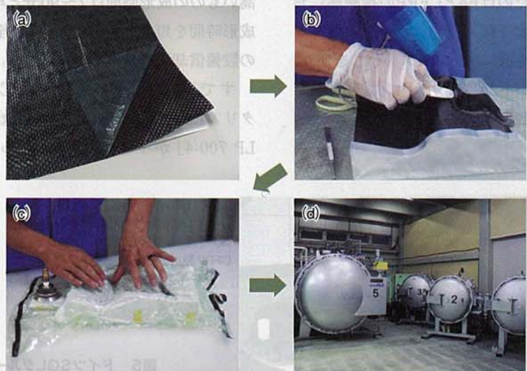
図A プリプレグ+オートクレープ成形の手順
