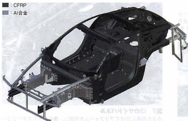
図10 トヨタ自動車「レクサスLFA」のホワイトボディ 質量は193kgで、そのうちCFRPが65%、Al合金が35%を占める。
