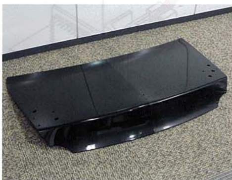
図18 三菱レイヨンの熱プレス成形品 熱硬化性のUDプリプレグを予備成形してから熱プレスする。質量は2.4kgでAl合金製トランクリッドより40%軽量化。内側の骨組みはオートクレーブで成形し、接着。
