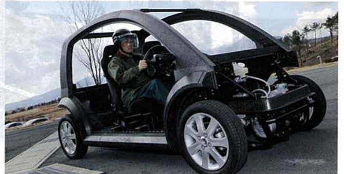
図2 帝人の熱可塑性CFRPの試作車 下部のプラットフォームは樹脂にPA(ポリアミド)、ピラーから上部はPP(ポリプロピレン)を用いる。(写真:山本琢磨)
