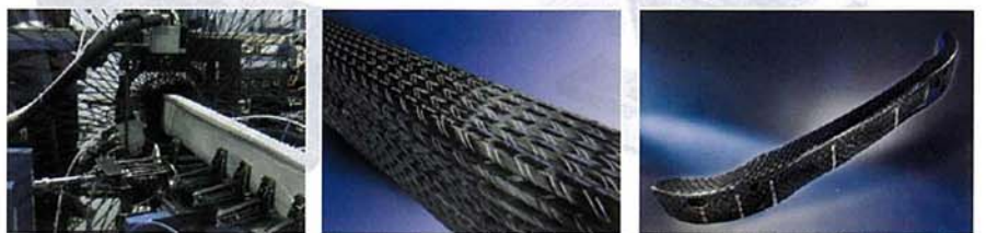
図9 先代「M6」のバンパービームも組物のプリフォームを使う 成形はSGL Kumpers社が担当。左からAugust Herzog社の編み機、組物のプリフォーム、RTM成形品。
