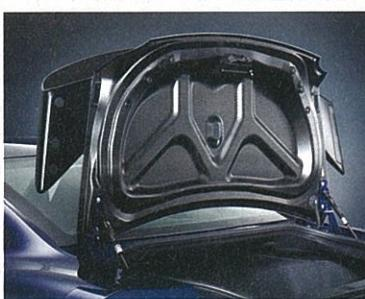
図A●PCM法で成形したトランクリッド
