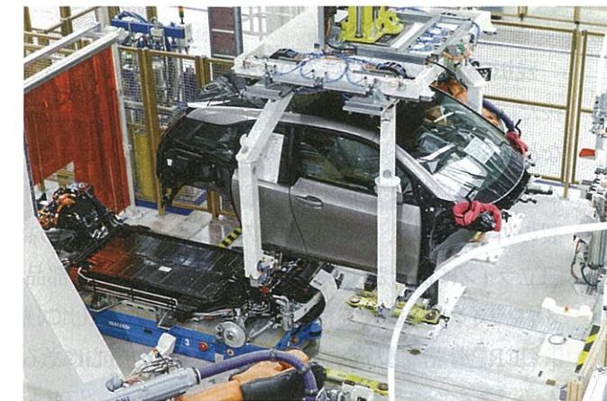
図3●CFRP骨格と下部シャシーの一体化
