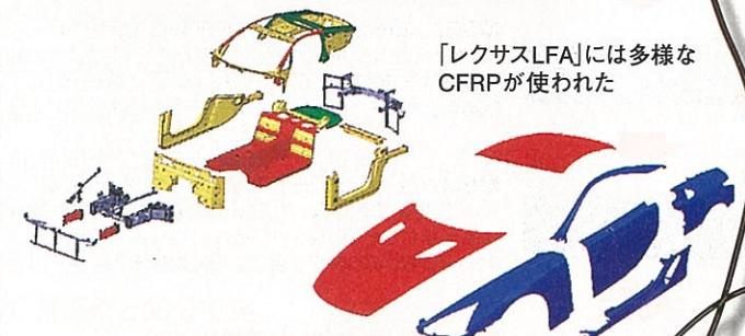
「レクサスLFA」には多様なCFRPが使われた
