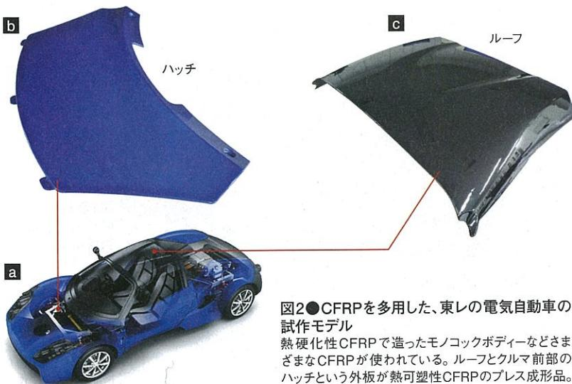
図2 CFRPを多用した、東レの電気自動車の試作モデル
