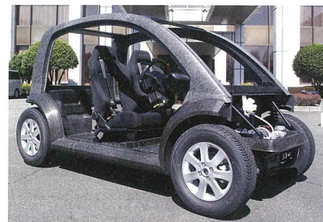
図1●熱可塑性CFRP
