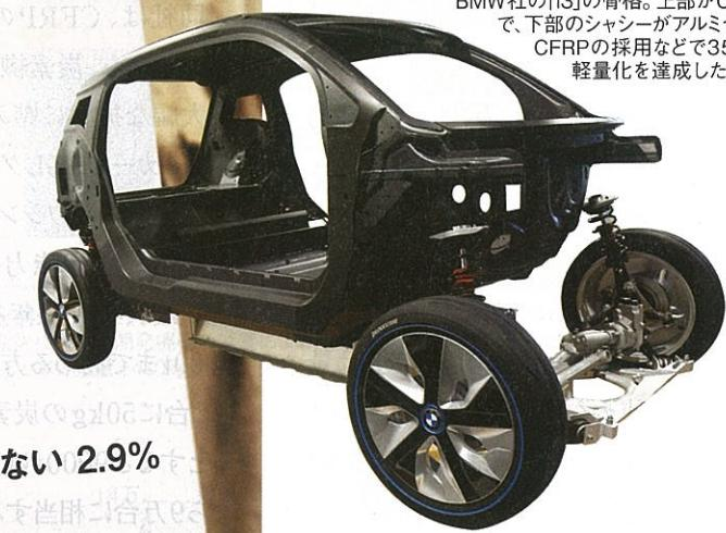
BMW社の「i3」の骨格。上部がCFRP製で、下部のシャシーがアルミ合金製。CFRPの採用などで350kgの軽量化を達成した。
