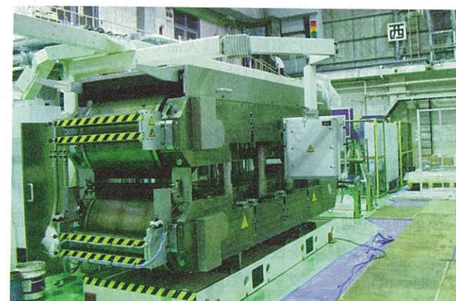
図6 ダブルベルトプレス装置の本体 周辺装置を含めると20×10mという大型の装置である。
