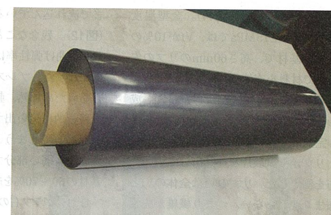
図7 ロール状の等方性中間基材 フープ材のように連続で取り扱える。マトリックスはPP。
