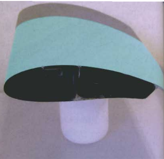
(a)は正面から、(b)は上面から見た。CFRP製。航空機の翼を基に形状を決めた。
