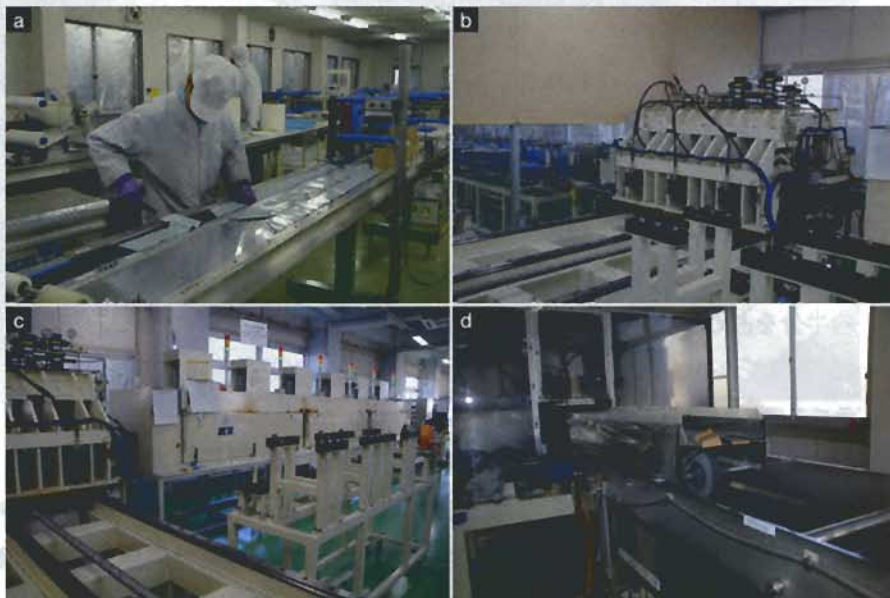
図5 ●ADP法を適用したフロアクロスビームの製造ライン(ジャムコ)
