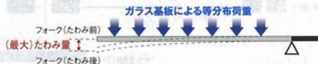
図B●ガラス基板の荷重によるたわみ フォークを片持ちばりと考えた場合、ガラス基板による等分布荷重を受け、先端が最もたわむ。
