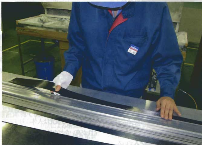
図2●各パターンを張り合わせる工程 積層の仕方でも釣りざおの特性を調整する。
