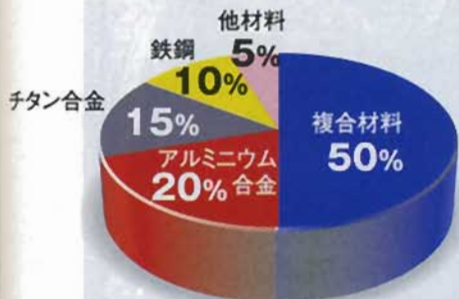
図10「787」における各種材料使用状況 外から見える部材は、ほぼすべてCFRP。使用比率(質量)でもCFRPなど複合材料が約半分を占める。提供はBoeing社、和訳は本誌。
