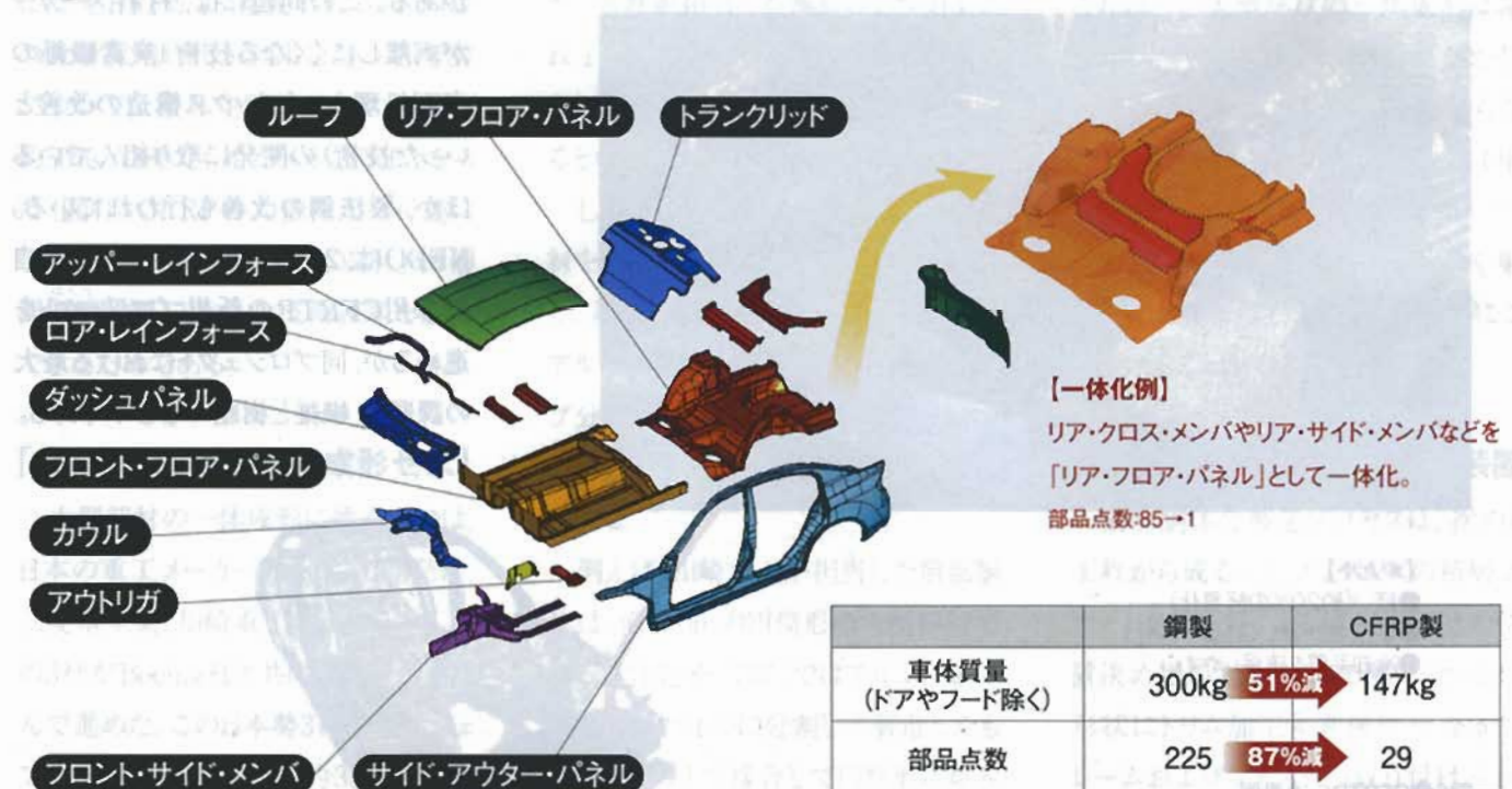
図5●部品点数削減の事例 CFRP化によってプラットフォーム部品を一体化し、部品点数を削減。軽量化も実現した。日産自動車の資料を基に本誌が作成した。
