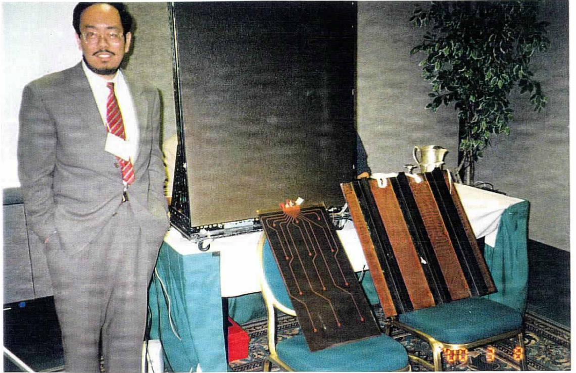
CFRP Panel/Piezo sensor 外付けタイプ
