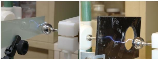
Fig.16 試験片の位置をずらした場合の円孔付き平板試験片へのスパーク挙動(左:PP,右:CFRP)
