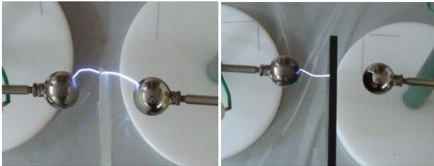
Fig.13 アース時の平板試験片へのスパーク挙動(左:PP,右:CFRP)
