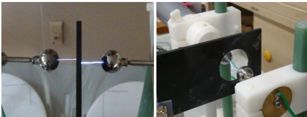
Fig.15 非アース時のCFRTP試験片へのスパーク挙動(左:円孔無し,右:円孔有り)
