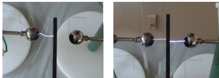
アースされているCFRPで遮蔽
