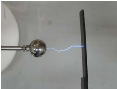
溶着接合を行った試験片で遮蔽
