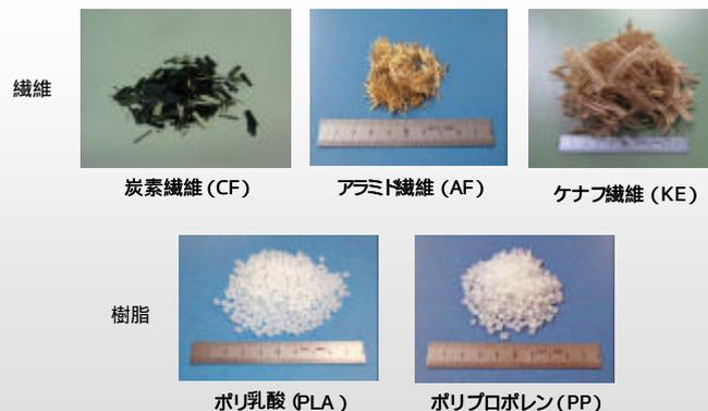
3種類の繊維と2種類の樹脂を用いて計6種類の試験片を作成した。
