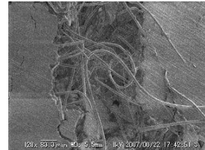
図28 アラミド7mm破断面
