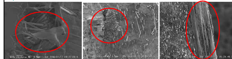
未処理曲げ破断面 未処理衝撃破断面 熱解織衝撃破断面
