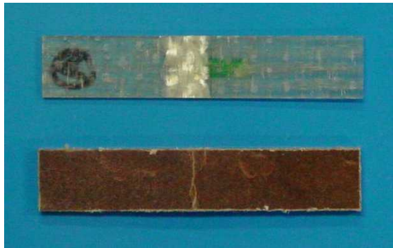
Fig.6: GFRP と KS30/PLA の曲げ試験片
