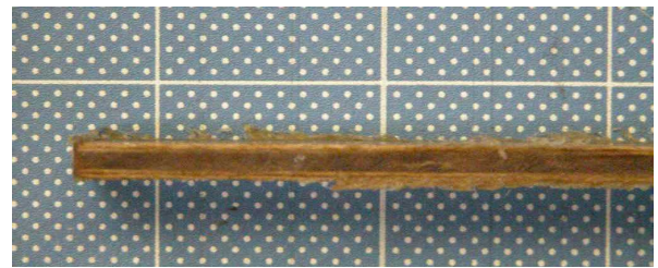
Fig.8: サンドイッチ材 (Sand 50) の断面
