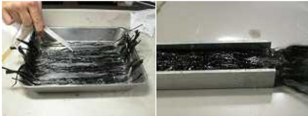
図 5 エポキシ塗布 図 6 金型内に CF 配置
