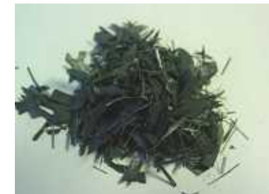
破碎CFRP 1mm～15mm CF/Epoxy Vf60 %
