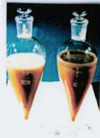
液液分離の状態 ブタノール相: Pd 水相: BaTiO 3
